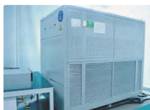
防孤岛试验装置
